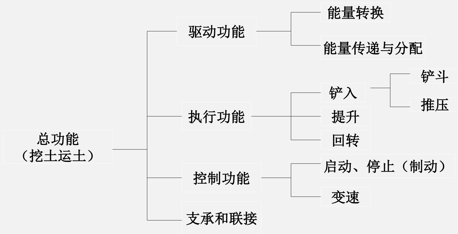
图2-19 挖掘机的分功能
